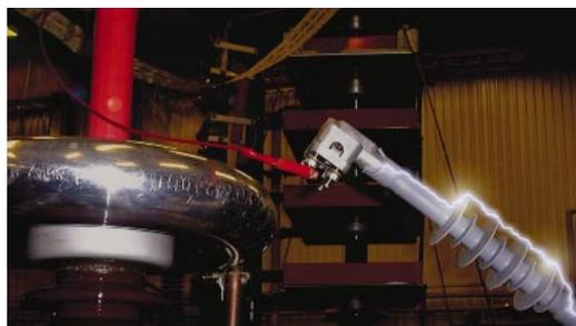
Электрический разряд на концевой кабельной муфте во время испытания.
