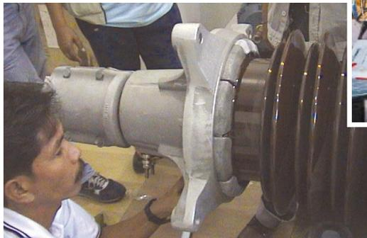
Наши концевые кабельные муфты можно тщательно собрать в горизонтальном положении на земле, а затем поднять на место установки, что делается легко и безопасно.
